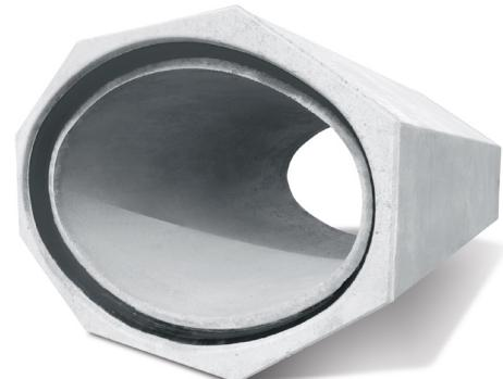
**Sa forme unique - section intérieure elliptique et géométrie extérieure octogonale - lui confère une grande adaptabilité aux configurations de chantiers variées.** Réversible, le tuyau MODULOVAL® peut être posé aussi bien horizontalement que verticalement par emboîtement mâle-femelle. Il est équipé en usine d'un joint intégré, assurant une mise en œuvre rapide et une parfaite étanchéité.
